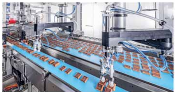
Insgesamt acht F4-Arme ermöglichen im Doppelpick-Verfahren eine besonders schnelle und flexible Verarbeitung von Schlauchbeutel- und Tray-Produkten.
