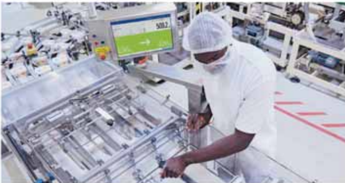
Blue HMI bei der Anwendung dynamische Kontrollverwiegen: Klare Strukturen und Full-HD-Visualisierungen sorgen für höchste Bedienfreundlichkeit und Prozesssicherheit.
