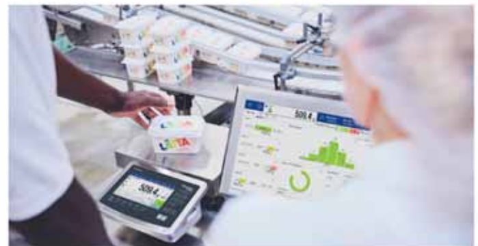
Blue HMI im Einsatz mit einem Wägeindikator beim statischen Verwiegen: Einheitliche Workflows erleichtern die Bedienung und steigern die Effizienz in der Produktion.
