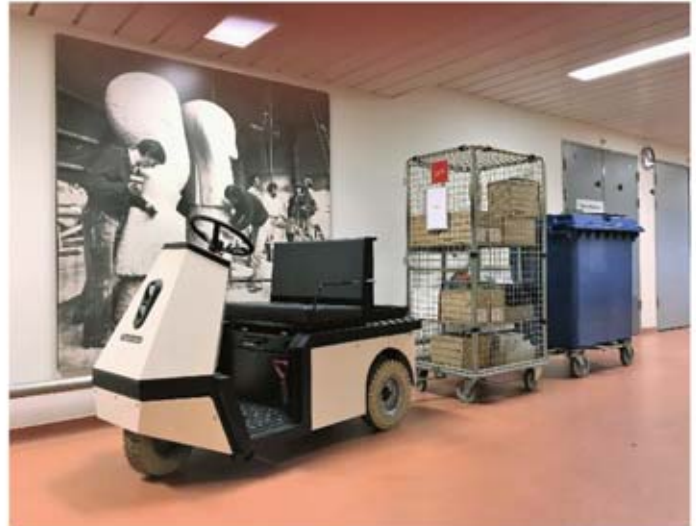
SPLUKSTAAL 304 – Kompakter Schlepper mit tiefem Einstieg und Schleppleistung bis zu 4000 kg.
