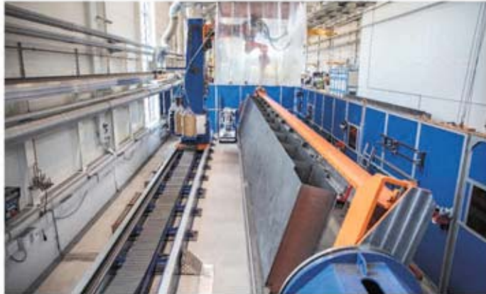
Die Masten wurden im Stöcklin Technologie Center auf der Schweissroboteranlage gefertigt ...
