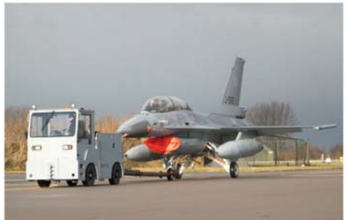
ATA E800 – 4x4 Elektroschlepper mit Allradlenkung und Schleppleistung bis zu 80000 kg.
