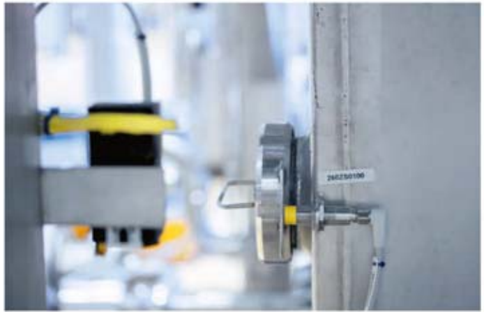
Induktive Sicherheitssensoren stellen sicher, dass kleinere Öffnungen korrekt verschlossen sind. (Alt: Induktiver Safety-Sensor an einer Edelstahlklappe)
