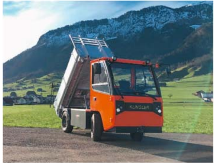
Klingler EGT 6024 3KP – 3-Seiten-Kipper mit über 3000 kg Nutzlast und 3500 kg Anhängelast.
