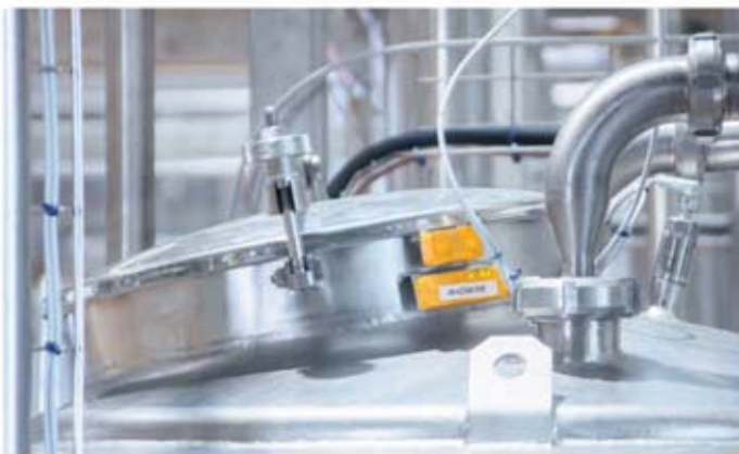
Mannlöcher werden mit RFID-codierten Safety-Sensoren gesichert. (Alt: Safety-Sensor an einem Mannloch eines Lebensmittelanks)
