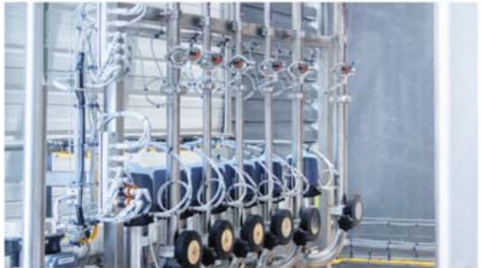
Induktive Sicherheitssensoren stellen sicher, dass kleinere Öffnungen korrekt verschlossen sind. (Alt: Induktiver Safety-Sensor an einer Edelstahlklappe)
