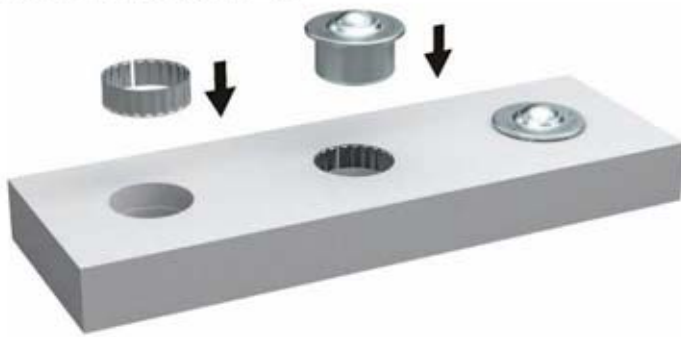
Montage einer Kugellrolle mithilfe eines Toleranzrings. (Quelle: Bosch Rexroth)
