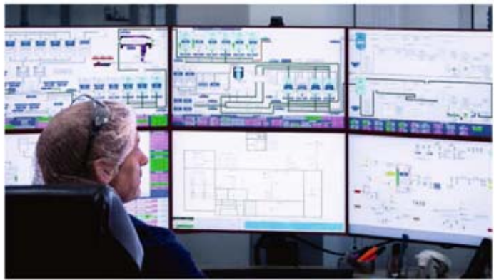
Zentrale Prozessüberwachung: Dank digitaler Kommunikation via AS-i und IO-Link kann der gesamte Prozess zentral im Blick behalten werden. (Alt: Sechs Monitore, auf denen Produktionsprozesse angezeigt werden.)
