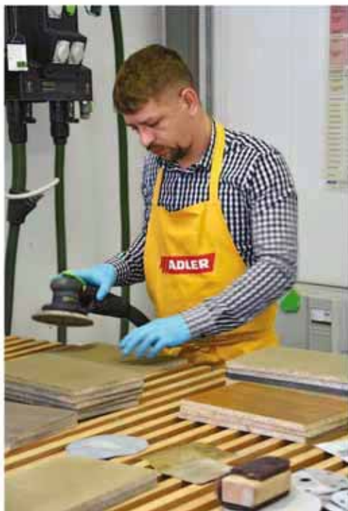
Eine sorgfältige Untergrund-Vorbereitung ist bei Wasserlacken besonders wichtig, um ein gleichmässiges Oberflächenbild zu erzielen. (Foto: ADLER)
