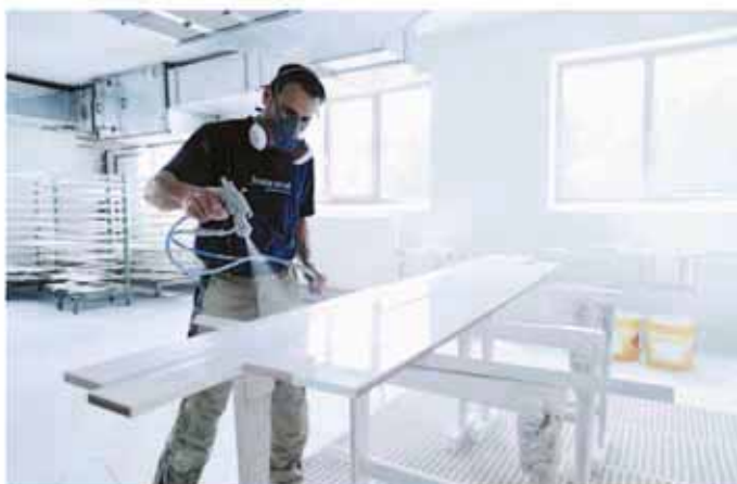
Die Umstellung auf Wasserlacke erfordert meist nur geringfügige Anpassungen im Lackiererraum und bietet deutliche Pluspunkte für den Verarbeiter. (Foto: ADLER)
